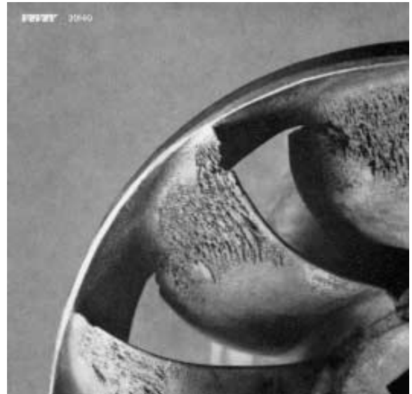
Plages cavitées sur l'extrados de l'aubage d'une roue Francis
