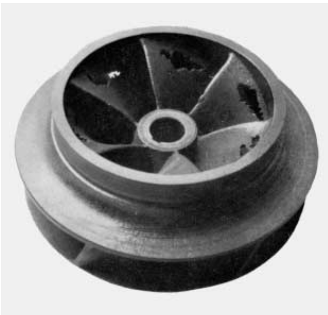
Roue de pompe radiale détruite par cavitation
