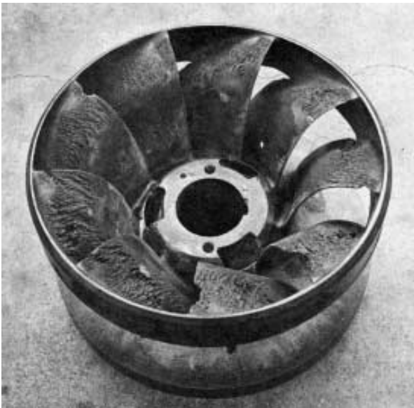
Roue de turbine Francis érodée par cavitation
